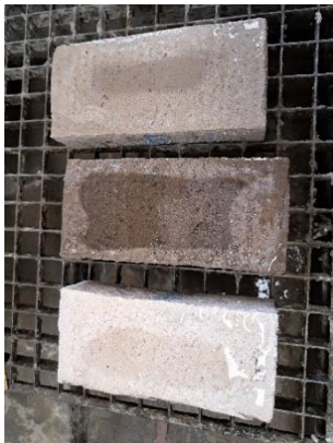
Afb: Praktijkvoorbeeld waterabsorptie hechtvlak gehydrofobeerde steen
